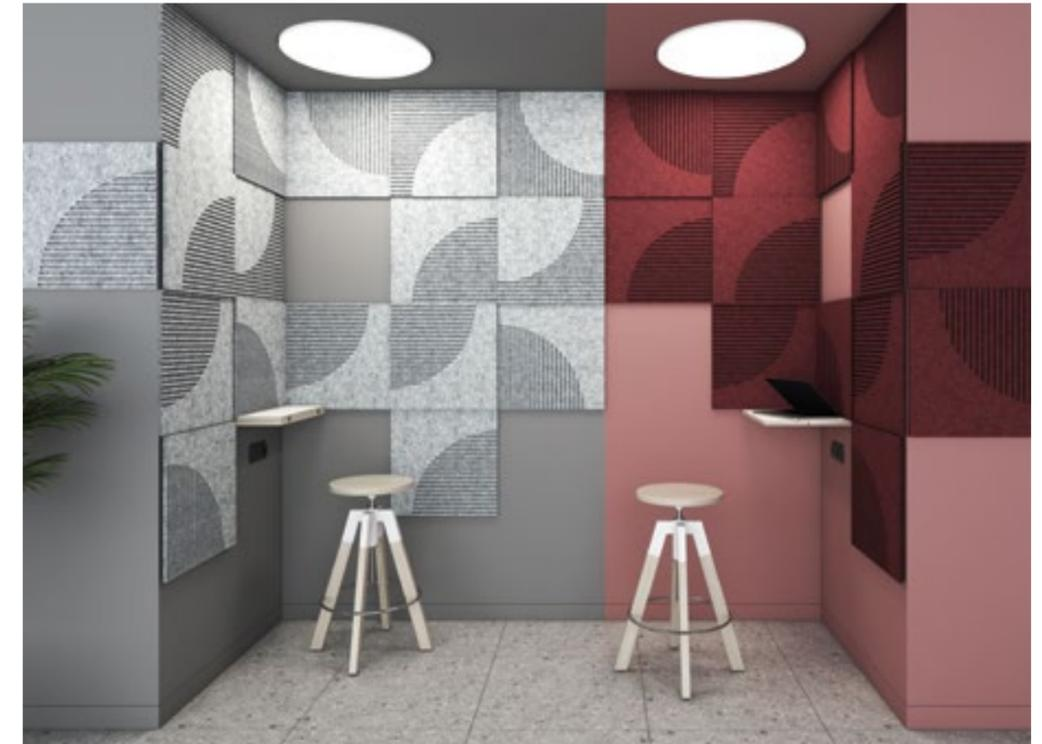
Panele akustyczne PET i filc akustyczny tworzone w zgodzie z ideą ochrony środowiska, poza podstawową funkcją absorbowania dźwięków, częściowego odbijania lub przenoszenia fali dźwiękowej, dodatkowo doskonale oddzielają ciągi komunikacyjne, tworzą strefy spotkań i wypoczynku oraz zapewniają komfort akustyczny w obrębie poszczególnych stanowisk pracy.
